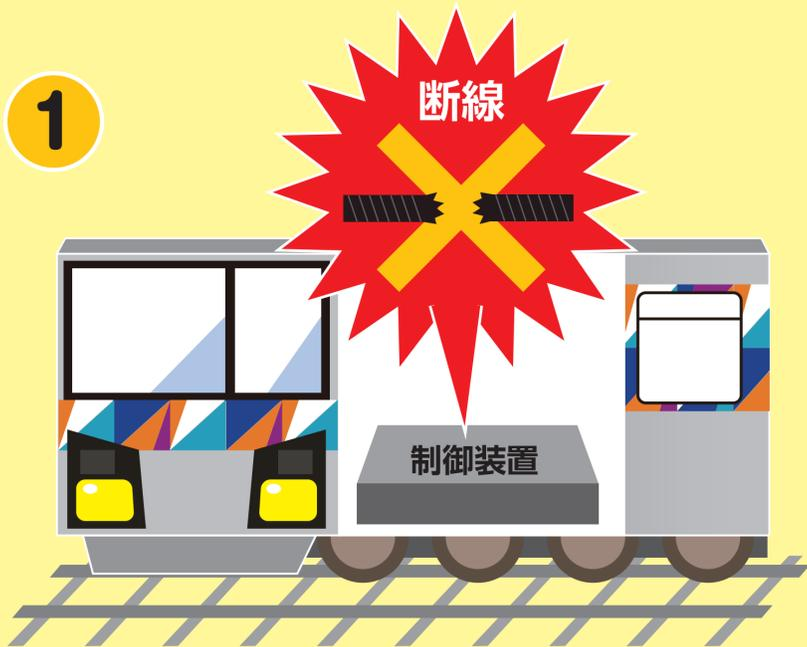
断線によりモーターを制御する装置の進行方向が切替わらず、その状態のまま列車が出発したため逆走事故が発生しました。
